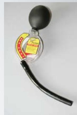
L'hydromètre mesure la densité de l'antigel en indiquant les points de congélation et d'ébullition.
