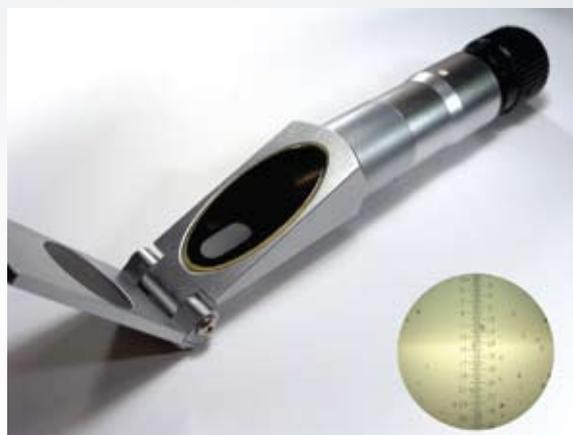
Le réfractomètre utilise l'opacité de l'antigel pour laisser passer plus ou moins de lumière et affiche le résultat sur une échelle graduée.
