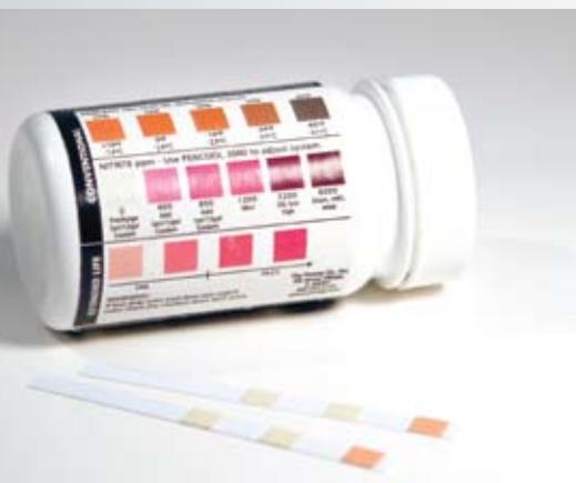
Les bandelettes de test emploient un code de couleur pour indiquer la condition de l'antigel de diverses façons.
